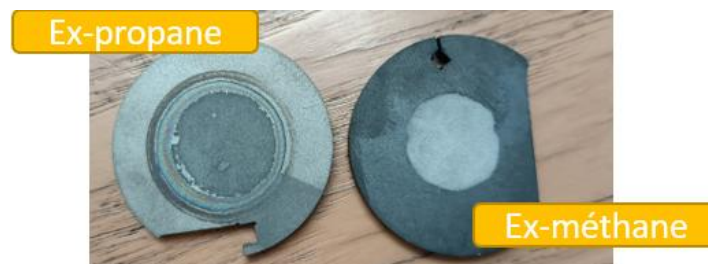
Figure 1 : Photographie d'échantillons de PyC sur alumine ( \varnothing = 3 cm) après test d'adhérence
